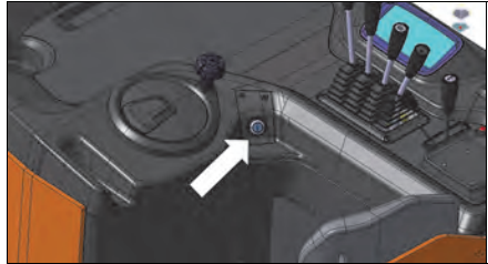
15. 키 스위치를 OFF 시키고 배터리 커넥터를 분리하십시오.
