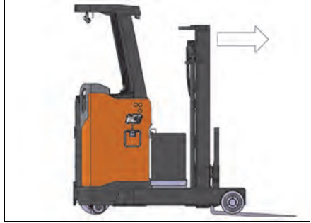
14. 록킹 페달을 밟은 후 배터리 케이스와 마스트 어셈블리를 함께 리치 아웃 시키십시오.
